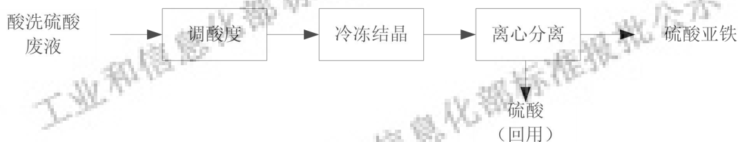
图1 冷冻结晶法工艺流程
