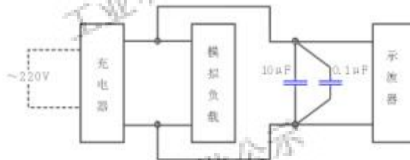
图 2 输出纹波接线图
